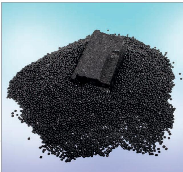
Expandiertes Polypropylen (EPP) besteht aus vorwiegend geschlossenzelligen Schaumstoffpartikeln, die auf Schäumautomaten zu Formteilen nahezu beliebiger Gestalt verarbeitet werden können.
